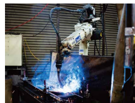
ロボット溶接機
